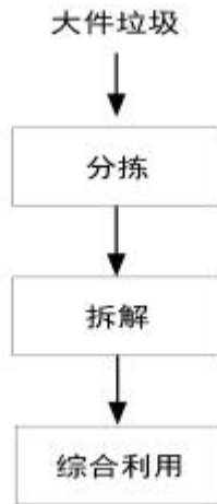
图 3-4 大件垃圾回收利用工艺流程
