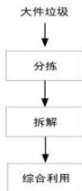
图4 大件垃圾回收利用工艺流程
