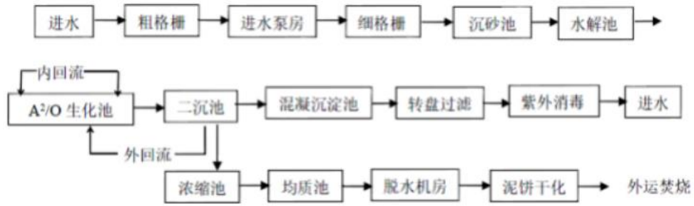
图 4-2 污水处理工艺流程图
